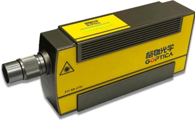
PNV-RD-AVD1激光多普勒测振仪是一款高性能、便携型单点激光测振仪。激光波长633nm，安全等级ClassII，贴反射膜场景下测量距离可达20米。用户可选自动聚焦机型，根据需要选择性测量位移、速度和加速度，该仪器采用全数字解调系统，支持数字和模拟输出，支持外触发，可接充电宝使用。
